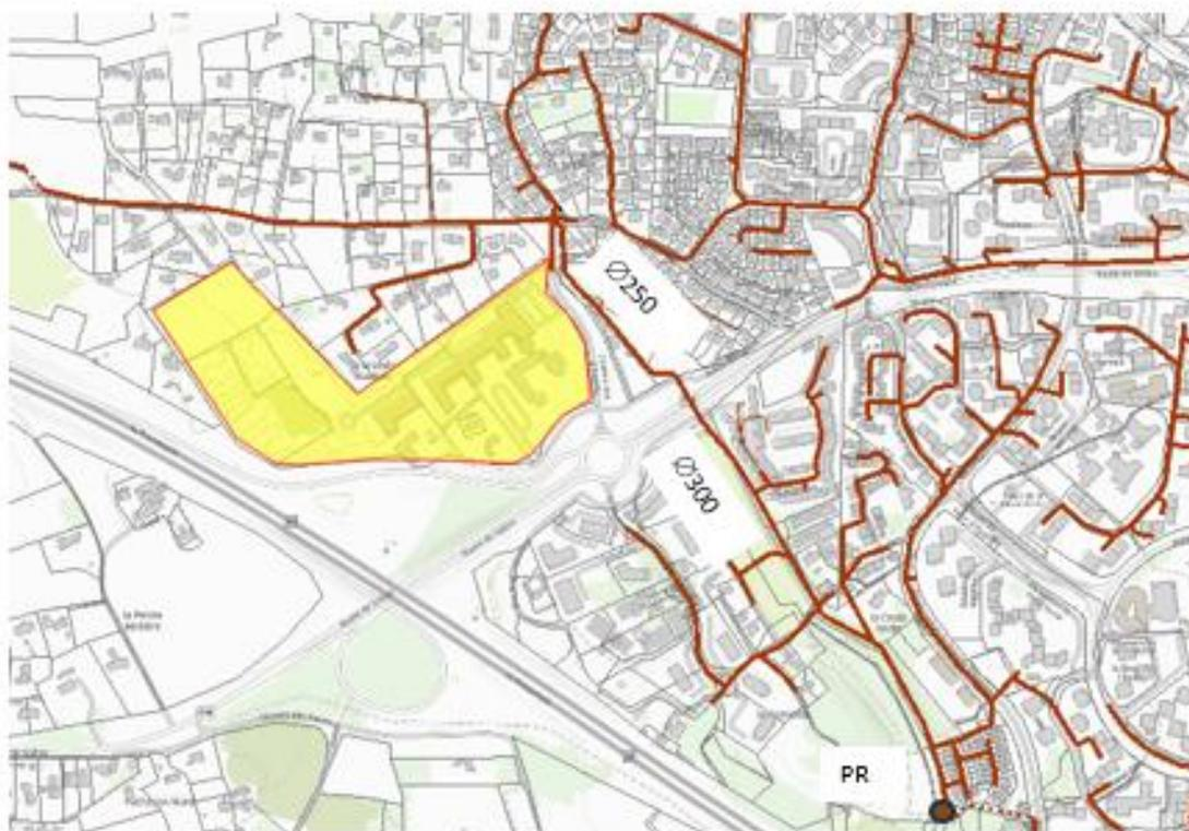
La zone d'étude est desservie par le réseau d'assainissement. La topographie est favorable à un écoulement gravitaire. Le poste de refoulement (PR) en place pour le quartier est de capacité suffisante à recevoir les effluents du projet mais des travaux d'aménagement devront toutefois être envisagés pour **s'adapter à l'augmentation du flux collecté**.
